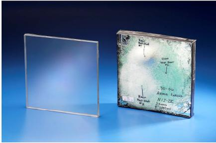
图7 透明氮氧化铝 (AION) 陶瓷
