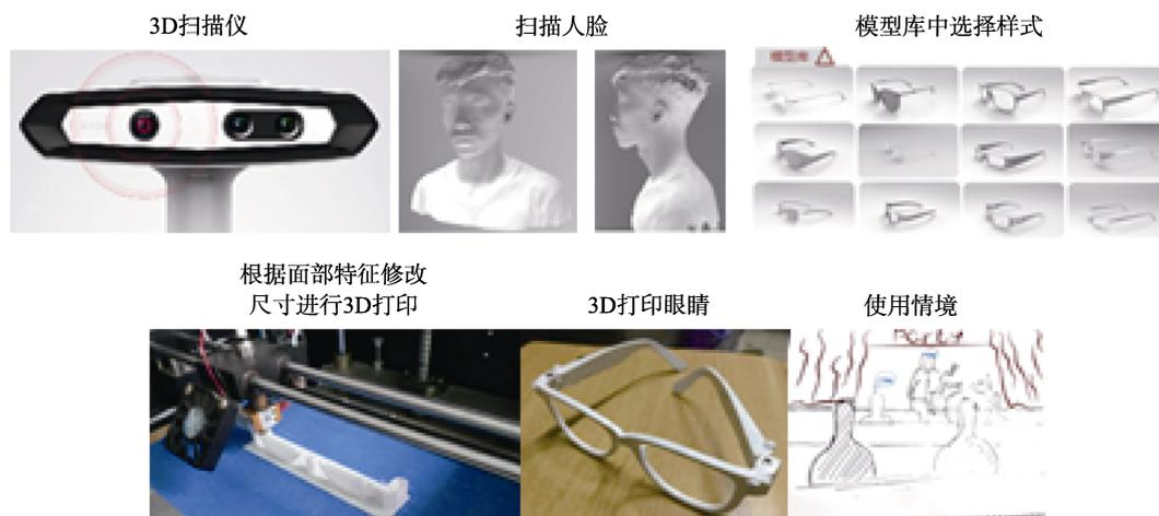
图 5 个性化眼镜创意设计 & 制造流程
