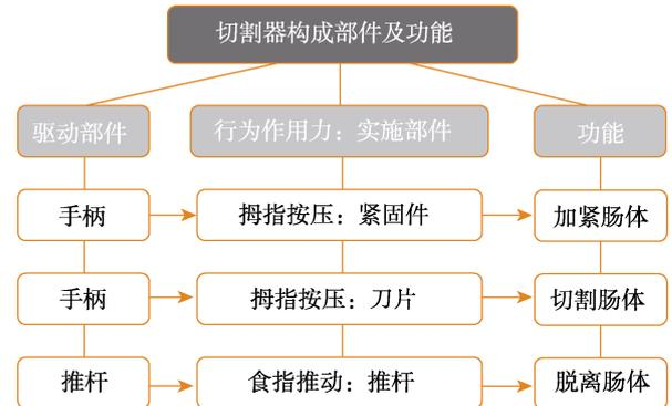
图 3 “铡刀式”切割器的基本构成部件
