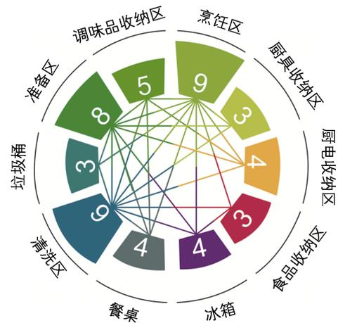
图 4 L 型厨房区域关系强度示意图
