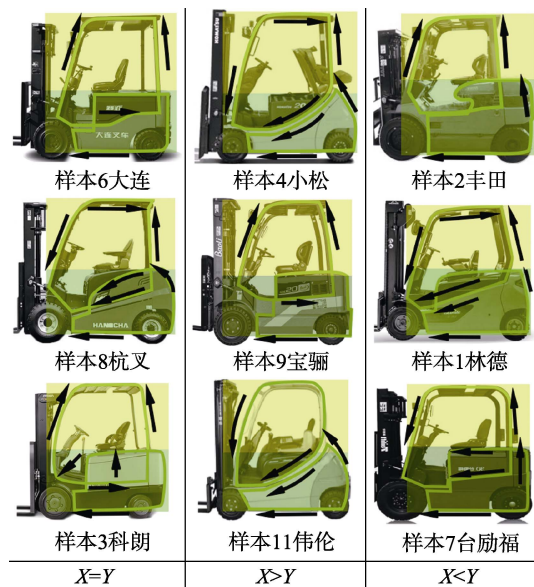
图 6 比例关系对视觉力的影响 Fig.6 Influence of proportion on visual force
