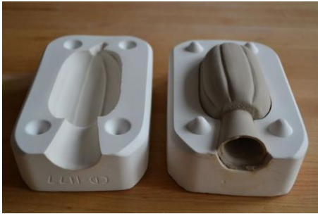
图 5 注浆石膏模具成型 Fig.5 Slip casting mold
