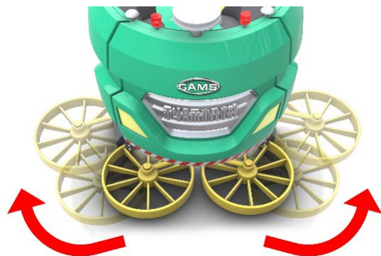
图 9 作业宽度可调的推料结构 Fig.9 Width-adjustable Pushing structure
