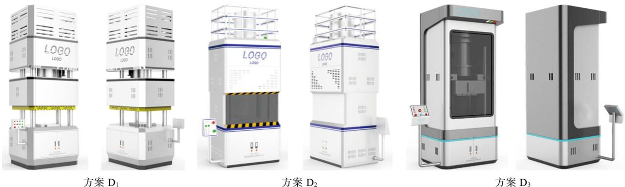
图4 四柱永磁粉末液压设备设计方案层 D
