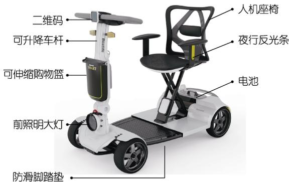
图4 共享老年代步车整车设计图
