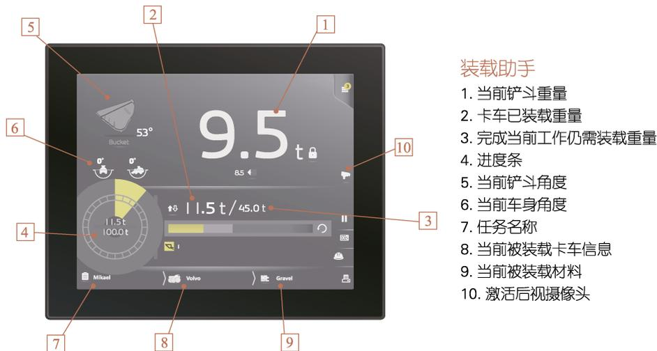
图8 沃尔沃装载助手HMI界面
